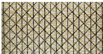
BAINBRIDGE DIAX 2. Består av aramid och svart technora, lagda i diagonala ribbor i 45 och 65 grader.
