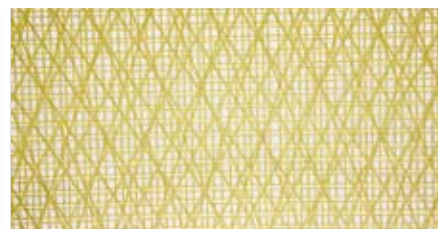
DIMENSION FLEX. Den här duken är gjord av aramidfibrer som är lagda i diagonala ribbor i 20 och 30 grader.
