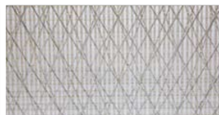
Den här multiaxiala duken består av Pentexfibrer och UV-film, men har även polyesterfibrer och taffeta i sig. Den är lämplig för rullningsbara segel.
